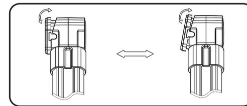
El mecanismo de apertura y cierre patentado. Asegura que ambos brazos se abran y cierren simultáneamente, lo que mejora la estabilidad de toda la estructura del soporte.
