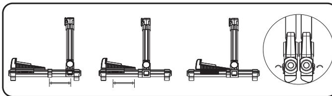
4. Abra todo el soporte para que tenga forma de A y colóquelo sobre una superficie horizontal. Coloque su instrumento en el soporte.
