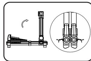
3. Mueva los brazos de soporte hacia adelante hasta el bloque de tope y bloquéelos. Las barras de soporte se ajustan hacia adelante y hacia atrás hasta un cierto espacio para diferentes instrumentos.
